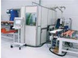
Mit dem neuen Schutz-System lässt sich der Lärm bei sachgerechter Auslegung der Einhausung um bis zu 25 dB(A) reduzieren Bilder: Minitec
