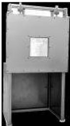
Für einen ungehinderten Zugang werden die Einrichtungen als Hauben mit Hubeinrichtung ausgeführt
